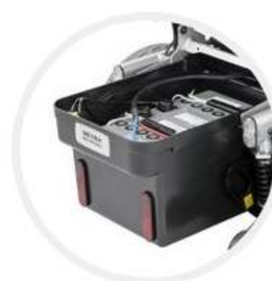
Servicefreundlichkeit Einfache Batteriewartung durch ausziehbaren Batteriekasten
